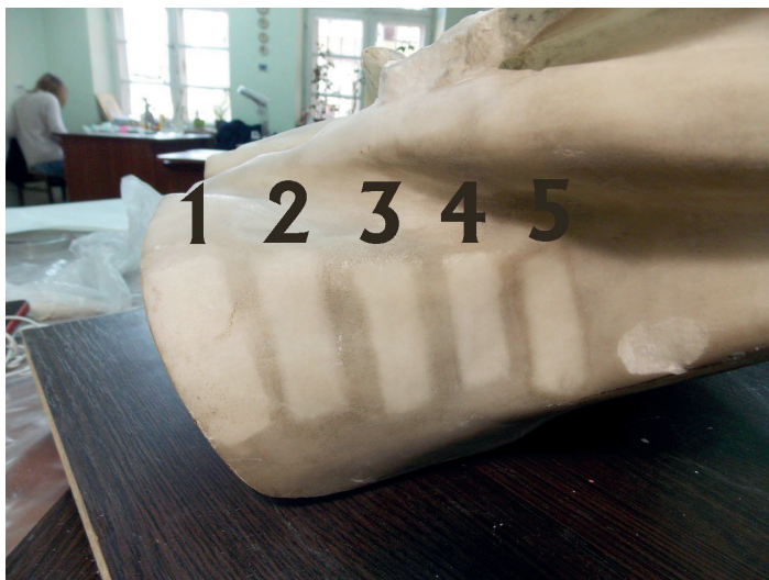
24. Wyniki oczyszczania za pomocą następujących środków: 1) klej PVA z gliceryną; 2) enzymy; 3) kwas cytrynowy (5%); 4) alkohol etylowy; 5) gąbka melaminowa Results of cleaning with following tools: 1) polyvinyl acetate adhesive with glycerine; 2) Enzystal; 3) citric acid (5%); 4) ethyl alcohol; 5) melamine sponge
